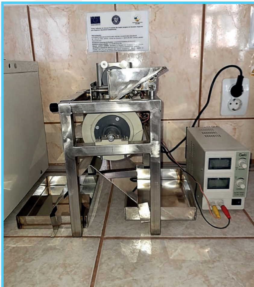
Instalație pilot (P-2) de recuperare prin separare magnetică a compușilor metalici cu proprietăți feromagnetice din reziduuri pulverulente (nămoluri/steriluri miniere uscate)
