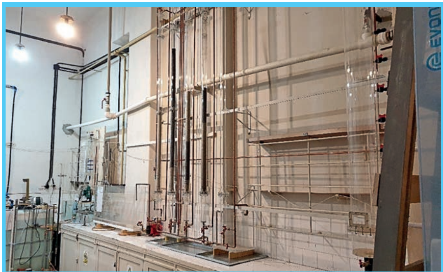
Imagine de ansamblu stație pilot de laborator de tratare ape
