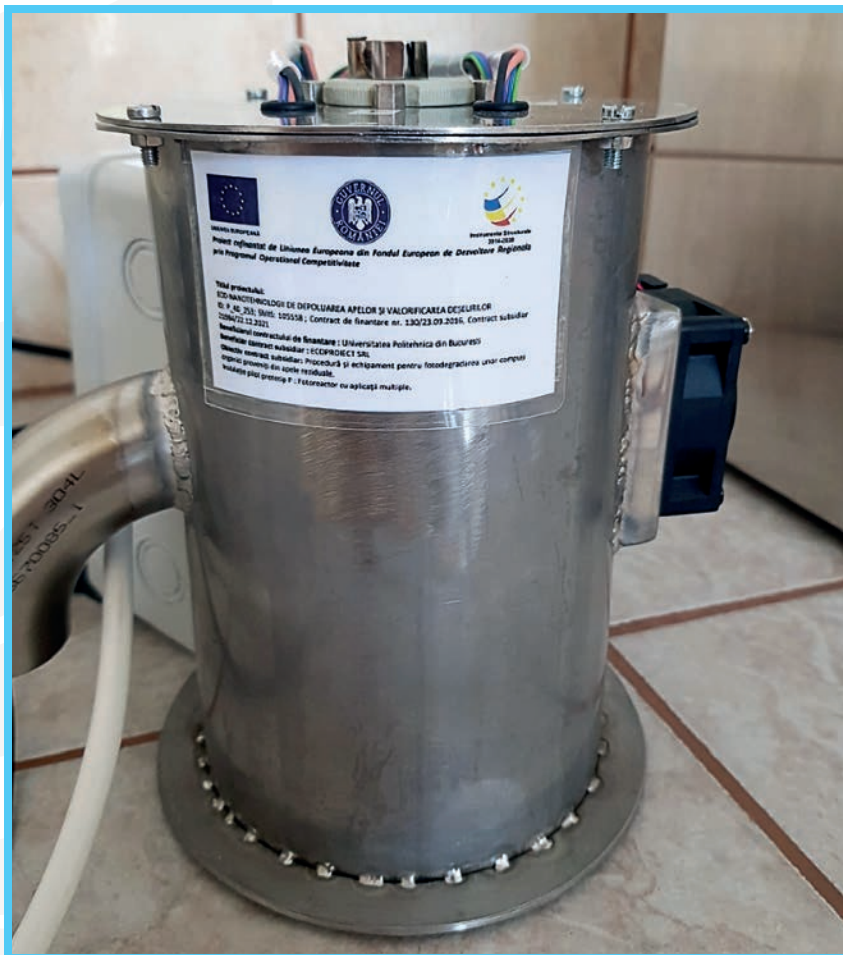
Echiptament pilot de tip fotoreactor cu aplicații multiple
