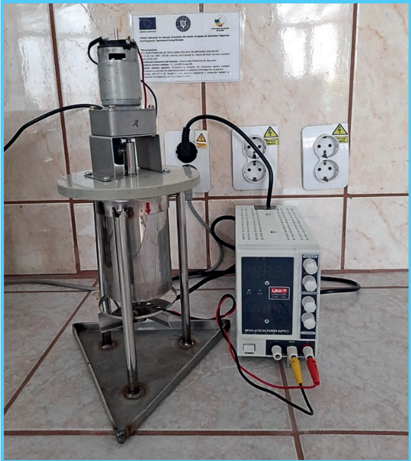
Instalație pilot (P-1) de recuperare prin separare magnetică a compușilor metalici cu proprietăți feromagnetice, în câmp magnetic rotativ
